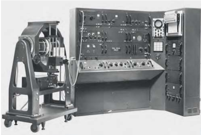
1957 Von ETH und TTC entwickeltes Kernresonanz-Spektrometer KIS1, ausgerüstet mit Permanentmagnet.
