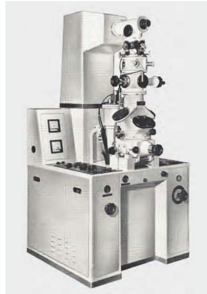
um 1955 TTC-Elektronen-Diffraktograf KD3.
