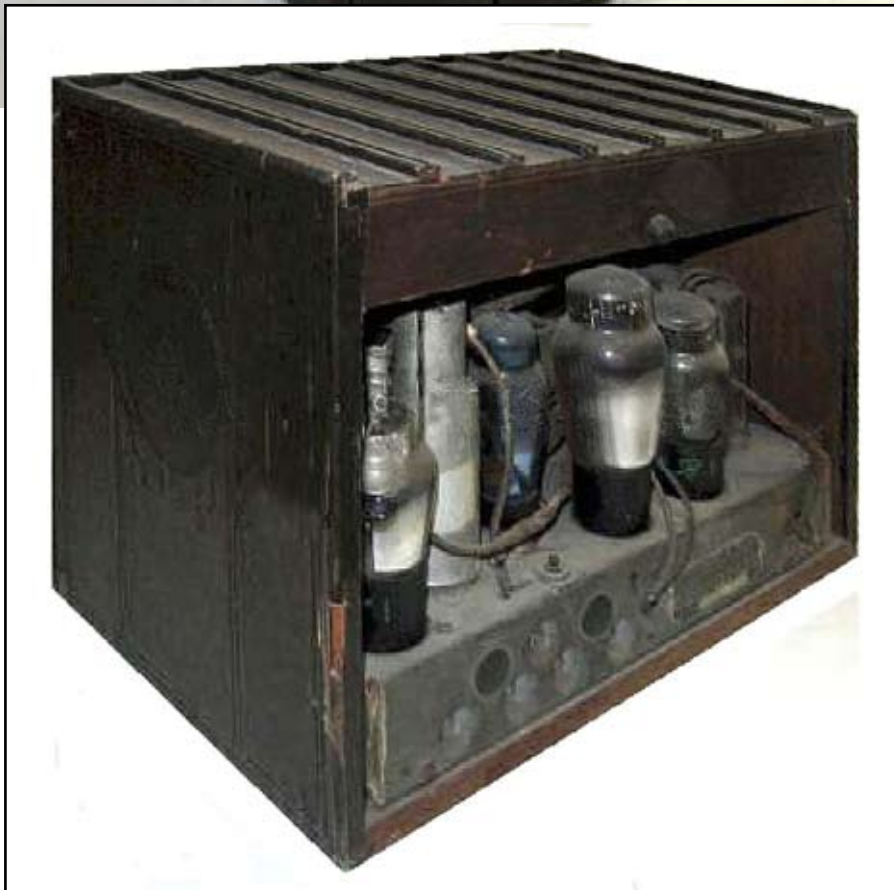
Crosley «Book Radio» Modell 141 von 1932/33: Die Bedienelemente und der Lautsprecher befinden sich hinter der Front (zwei Flügeltürchen)
