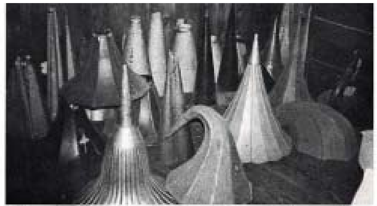
Bild 47. In den Laboratorien von West Orange fanden sich Ecken wie diese, in denen Trichter und nochmals Trichter für Walzenaufnahmen herumstanden. Für jede Aufnahmeart ein spezieller Trichter.
