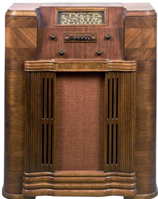
Firestone «Air Chief» S7399-2, 1942 (?) 7-Kreis-Super mit HF-Vorstufe Mittel- und Kurzwellen (iCollector.com)
