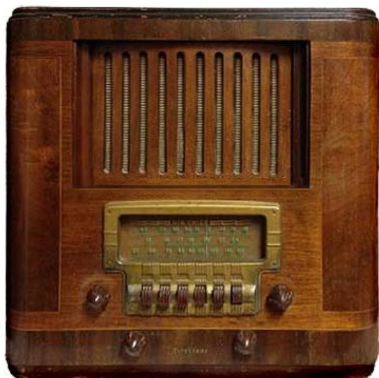
Firestone «Air Chief» S7399-2, 1942 (?) 7-Kreis-Super mit HF-Vorstufe Mittel- und Kurzwellen (iCollector.com)
