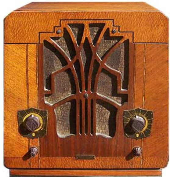
Goodyear 550, 1939 (?) 6-Kreis-Super, Mittel- und Kurzwellen (WorthPoint)
