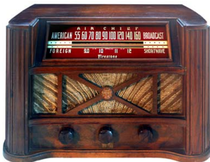
Firestone «Fire Chief» 4-A-20, 1946/47 7-Kreis-Super mit HF-Vorstufe Mittel- und Kurzwellen
