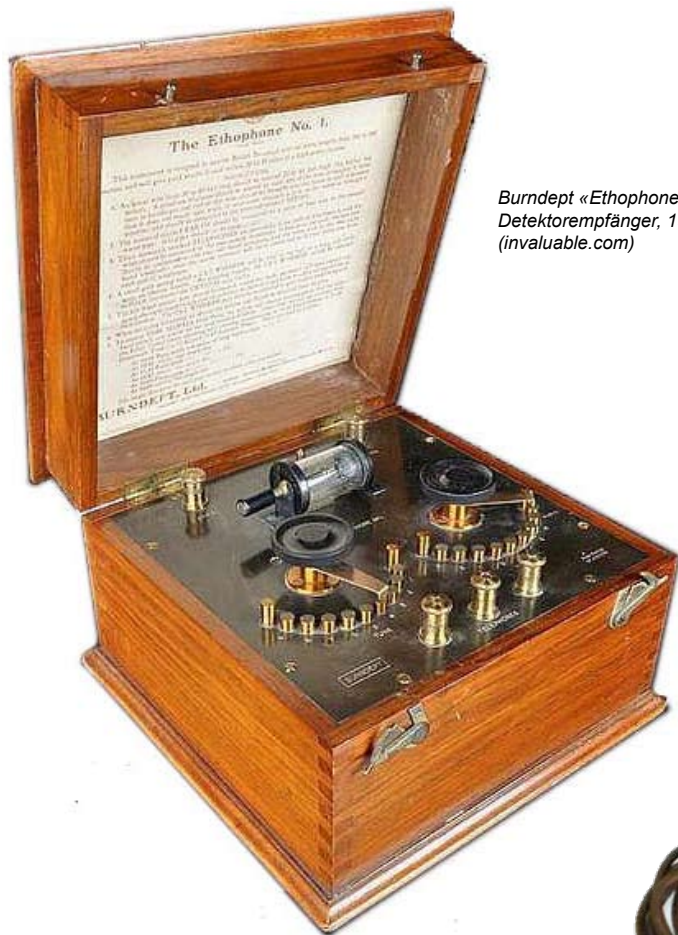
Burndeft «Ethophone Junior», Detektorempfänger, 1922 (invaluable.com)
