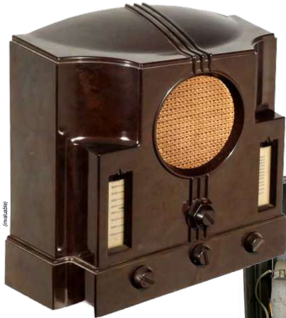
Defiant M900, 1935 Vierröhren-Mittel-/Langwellenempfänger (Geradeaus), in recht ungewöhnlichem Bakelitgehäuse
