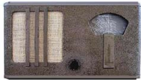
Paillard 29TR, Volksempfänger in Blechgehäuse, Mittelwelle, 1939/40
