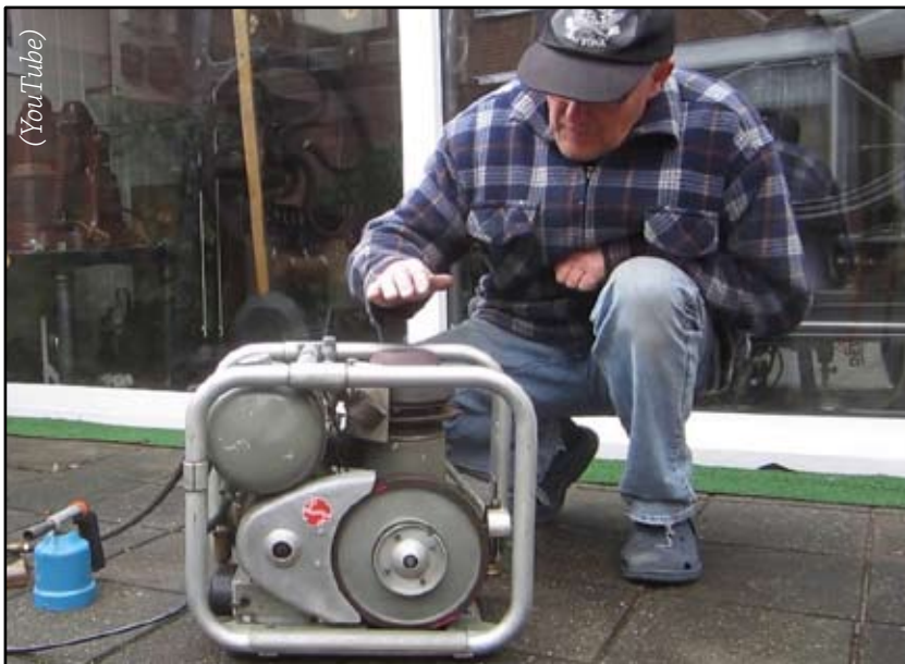
Philips Stirlingmotor: 1952 waren die Arbeiten so weit fortgeschritten, dass ein solches Stromaggregat in kleiner Stückzahl gebaut werden konnte; zur Serienfertigung kam es nicht.
