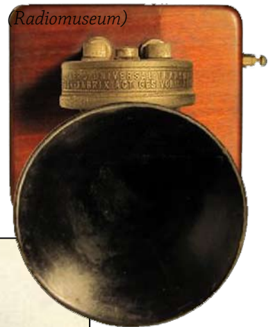
Tefag Mikrofon «Berliner's Universal Transmitter» (Kohlemikrofon), um 1900
