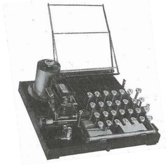
Abb. 217. Der Tastenlocher des Schnelltelegraphen von Pollak und Virag.
