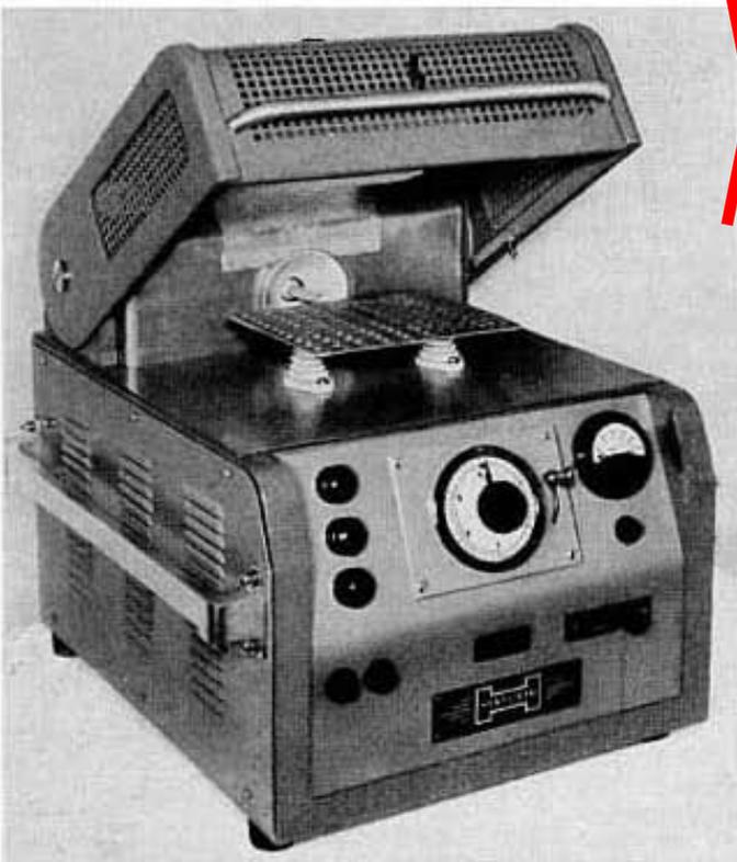
**Hochfrequenz-Vorwärmergeräte** für Kunstharz-Pressmassen gehören zum Fabrikations-Programm der Herfurth G.m.b.H. in Hamburg-Altona. Mit ihnen wärmt man in der Kunstharz-Presserei die Masse an, um so den Pressvorgang zu beschleunigen und die Pressform zu schonen. Die Vorwärmezeit wird mit der Uhr auf der Frotplatte eingestellt und automatisch beendet. Das abgebildete Tischgerät ist ein Typ für 500-W-HF-Leistung
