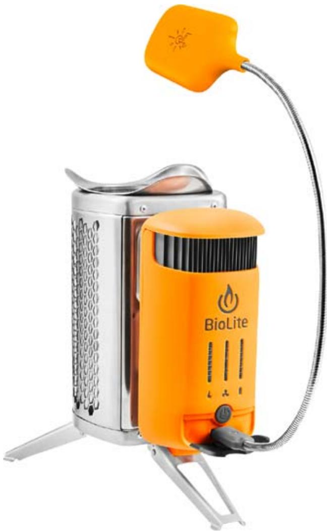
Der «BioLite»-Campingkocher (funktioniert mit Holz oder anderem Brennmaterial) ist mit einem thermoelektrischen Generator versehen, der – zur Intensivierung der Verbrennung – einen kleinen Ventilator antreibt und wohl auch zum Abkühlen der «kalten» Enden der Thermo-Elemente beiträgt. Deren Strom (1 bis 2 Watt) kann überdies zum Betreiben einer LED-Lampe oder auch zum Aufladen eines Handy-Akkus dienen.
