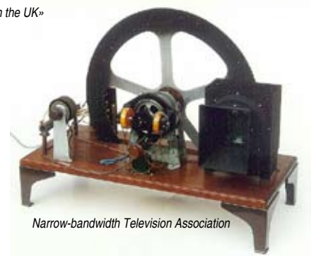
Das vom schottischen Ingenieur John Logie Baird entwickelte, ebenfalls mit der Nipkow-Scheibe arbeitende Fernseh-System hatte einigen Erfolg; vom «Televisor» sollen etwa 1000 Stück produziert worden sein.
