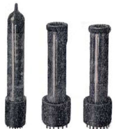
Verschiedene Ausführungen von Photozellen mit Elektronen- vervielfachern (Multipliern), entworfen und hergestellt an der Technischen Hochschule in Zürich
