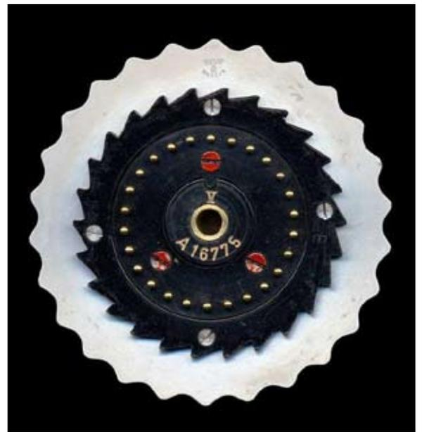
Walzensatz mit drei austauschbaren, rotierenden Walzen mit je 26 Einrast-Positionen; links eine «Umkehrwalze» (feststehend)
