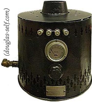
Thermattaix «Gasgenerator», 1927; Ersatz für die damals benötigten Radiobatterien
